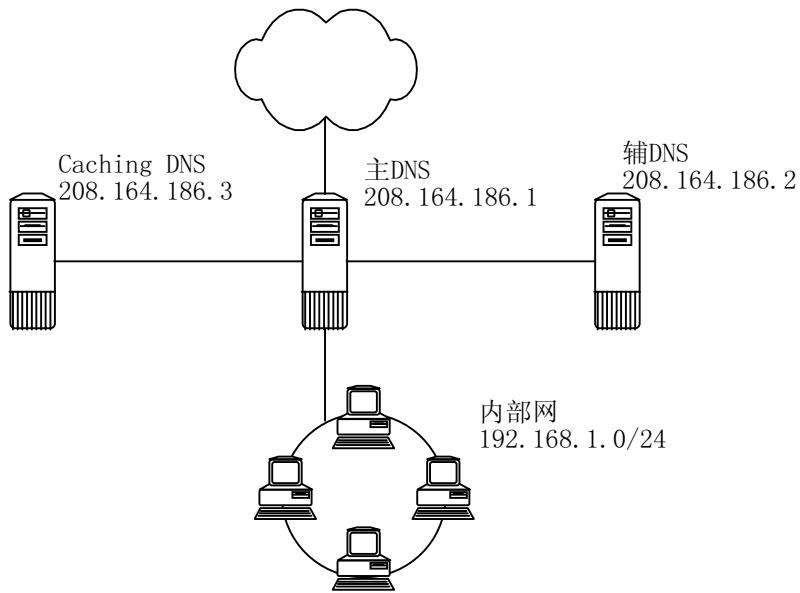
上面是我们在这本书中介绍的 DNS 的配置的图示。我们在不同的服务器上使用了不同的设置（caching only DNS、主 DNS 和辅 DNS）。在实际情况中有很多种可能存在，所以要根据需要和网络结构来配置。
